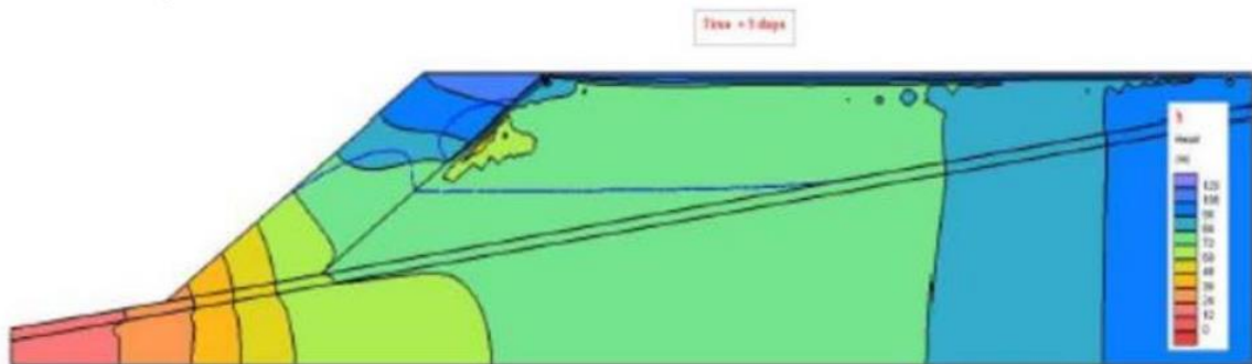
Figure 29. Nappe phréatique dans une HSG ( k_{cat}=1 \times 10^{-6} m/s) avec une face en matériaux fins ( k_{cat}=1 \times 10^{-7} m/s)
